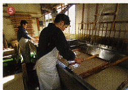
漉く:トロロアオイという植物の粘液を加え、数段階を経た後、槽に入れて水を加えて漉く。漉いた紙は積んで水気を絞る。
